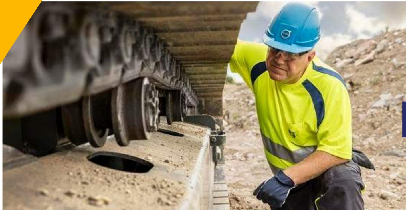
El carro inferior de una excavadora es uno de los elementos de la máquina expuestos a un mayor esfuerzo. No solo debe aguantar e impulsar el peso total de la máquina, sino que debe soportar también el impacto de rocas y otros obstáculos durante las operaciones. Las inspecciones del tren de rodaje minimizan las interrupciones en el trabajo y representan un ahorro en tiempo y dinero.
